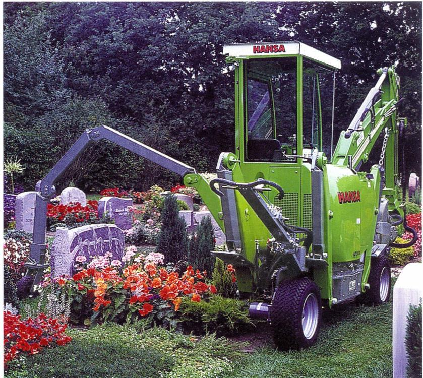
**Die Patentierte-Einspur** ist eine Sonderausrüstung. Damit fahren Sie den HANSA-APZ 131 auf Wegen mit bis zu 300 mm Breite. Ganz einfach, das linke vordere Antriebsrad wird mit einem Steckbolzen gelöst. Der Bagger wird dann spurstabil und standsicher über ein Stützrad im parallel verlaufenden Weg abgestützt gefahren.
