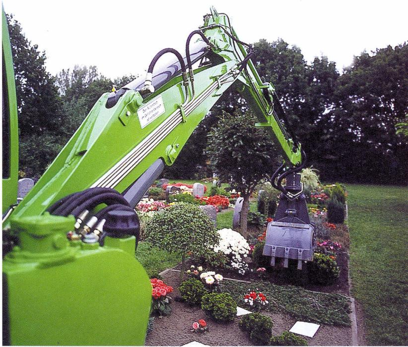
**Der Baggeraufbau** ruht auf einem absolut staubdichten Drehkranz. Der Turm ist im ganzen Arbeitsbereich uneingeschränkt 360° schwenkbar.
