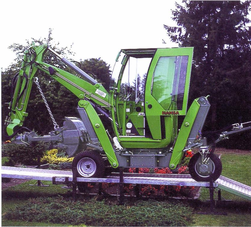
**Mit den HANSA-Überfahrrampen** bekommen Sie den HANSA-APZ 131 selbst über Treppen und Gräber in jede Arbeitsposition Ihrer Wahl. Mit nur zwei Personen ist ein sicherer Aufbau unseres Rampensystems leicht gemacht. Transportieren können Sie das Rampensystem auf unserem speziellen Anhänger.
