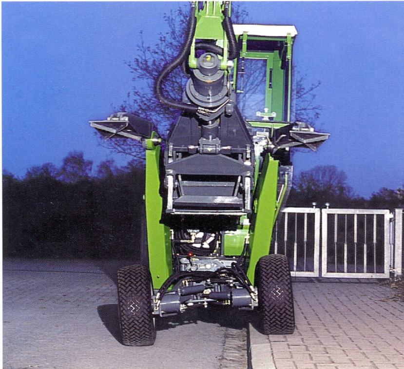
**Der Niveauegleich** ermöglicht bei Hanganlagen bis zu 20% Seitenneigung mit dem Bagger in komfortabler, senkrechter Position zu fahren und zu arbeiten. Ein Umsturz ist durch dieses spezielle Fahrwerk ausgeschlossen. Das spart Ärger und Kosten im Punkte Verletzungen und Beschädigungen.
