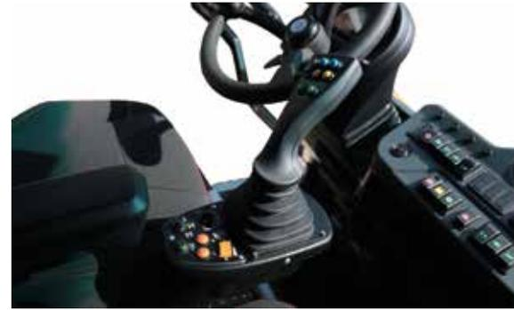
Individuell verstellbare Armlehne mit Multifunktionsjoystick inkl. Bedientasten für verschiedene Arbeitsmodi, Lenkungsarten, Tempomat und Handgas sowie Fahrtrichtungsschalter // *Individual adjustable armrest with multifunctional joystick incl. control buttons for different working modes, different types of steering, cruise control, hand throttle as well as a direction switch*
