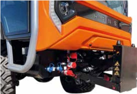
Massive Frontanbauplatte mit Parallelführung // *Massive front mounting plate with parallel guide*
