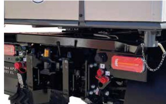
Schwere Anbautraverse zur Aufnahme von Heckanbaugeräten // *Lifting beam for picking up rear mounted equipment*
