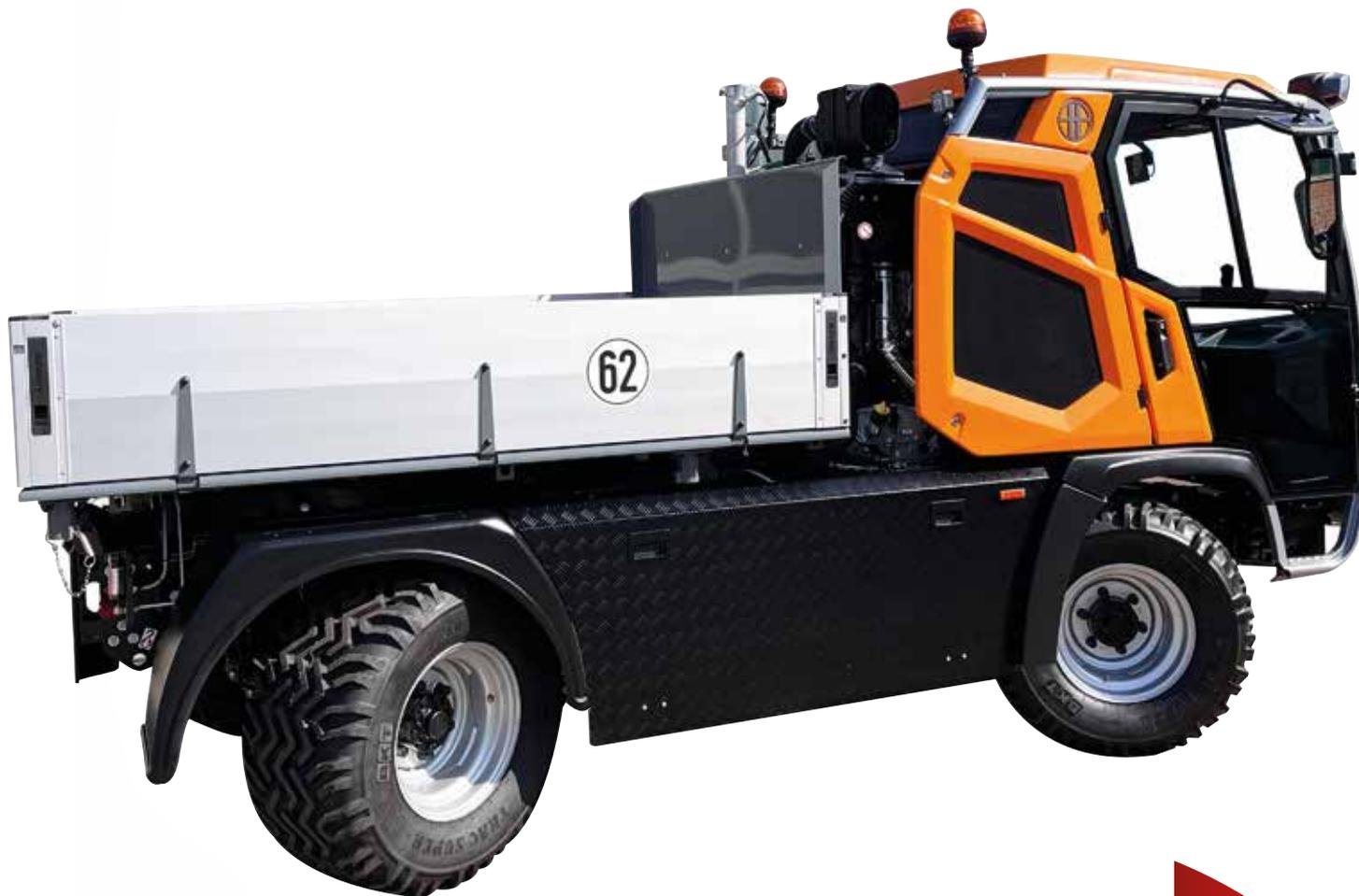
Die hydraulische Lenkung ist 4-fach schaltbar
