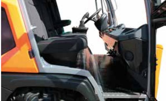
Fahrerhaus hydraulisch kippbar, beidseitiger Ein- und Ausstieg möglich; kein Mittelunnel vorhanden // *Spacious hydraulically tiltable cabine, getting in and out on both sides; no central tunnel*
