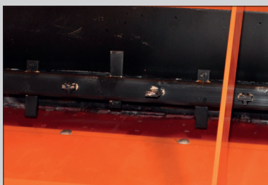
Epoke-Dosierungsprinzip mit Verteilerwalze und Umrührer.
